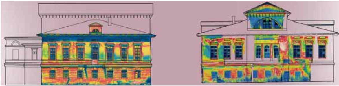
Иллюстрация 9. Наложение термограмм на чертежи фасадов здания. Фото автора
